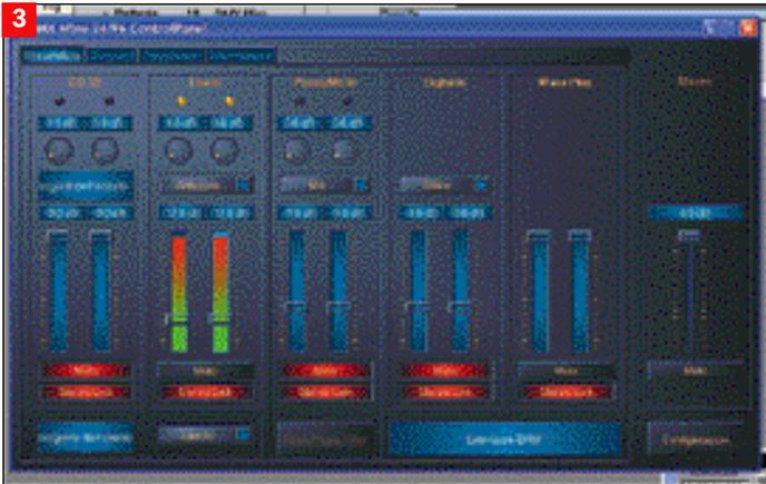
3 Tramite il pannello di controllo della Terratec Dmx 6Fire attiviamo l'ingresso Line In e regoliamo il livello di registrazione in modo da evitare distorsioni
