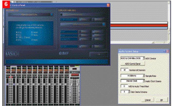
6 La configurazione ASIO consente di regolare la frequenza di campionamento ed altri parametri, e di aprire il pannello ASIO della propria scheda in cui settare il buffer per regolare la latenza del sistema
